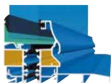
**2.** Ces menuiseries sont thermiquement très performantes puisque leur coefficient d'isolation UW est très bas, 25% sous la norme exigée par la RT 2012.
