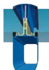
**6.** Nos chevrons de toiture sont tubulaires, c'est une véritable poutre intérieure, là encore l'esthétique et la rigidité ont été privilégiées. Ces poutres sont surmontées d'un T en PVC assurant la coupure thermique et recevant le matériau de toiture.
